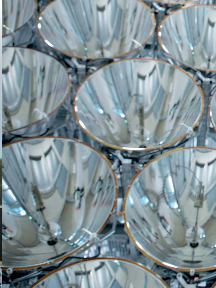
Synlight 共由 149 盏 7kW 短弧氙灯组成，每个灯泡单独拿出来都强大到足以在电影放映机中使用
